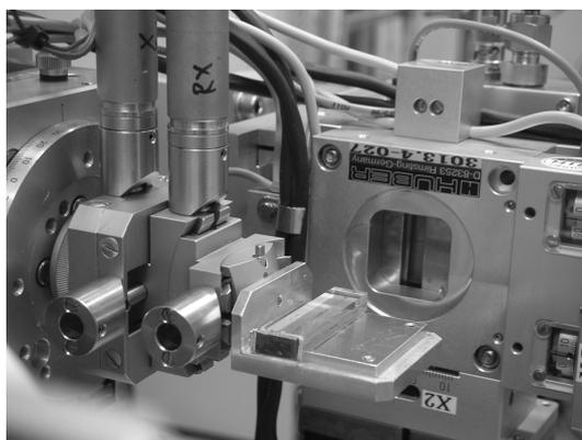
図 11: 鉛の板を付けたアナライザー (LiF)
