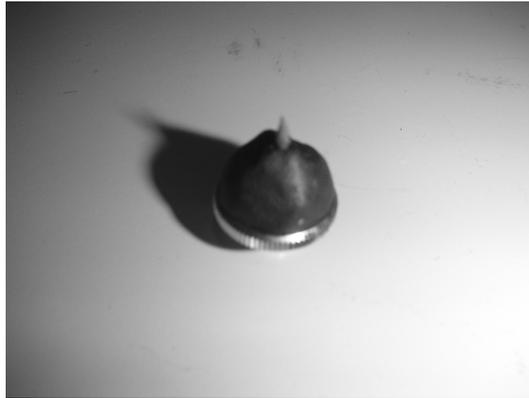
図 5: アナライザー軸中心設定用のピン
